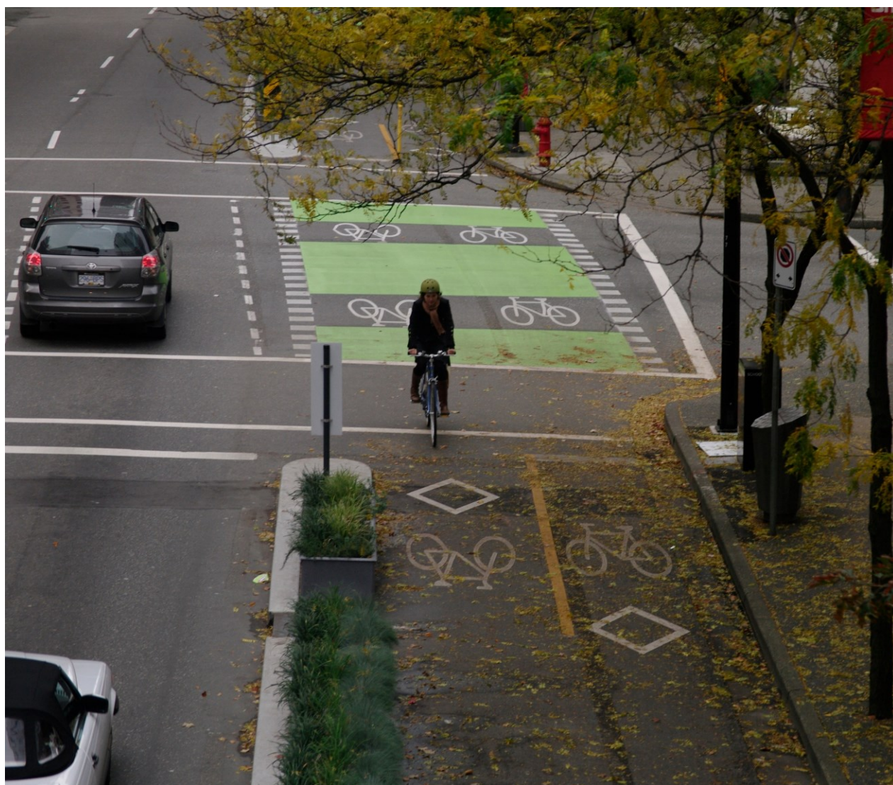
FIGURA 122 EXEMPLU PISTĂ PENTRU BICICLETE BIDIRECȚIONALĂ PE O PARTE A STRĂZII - STRADĂ SENS UNIC
